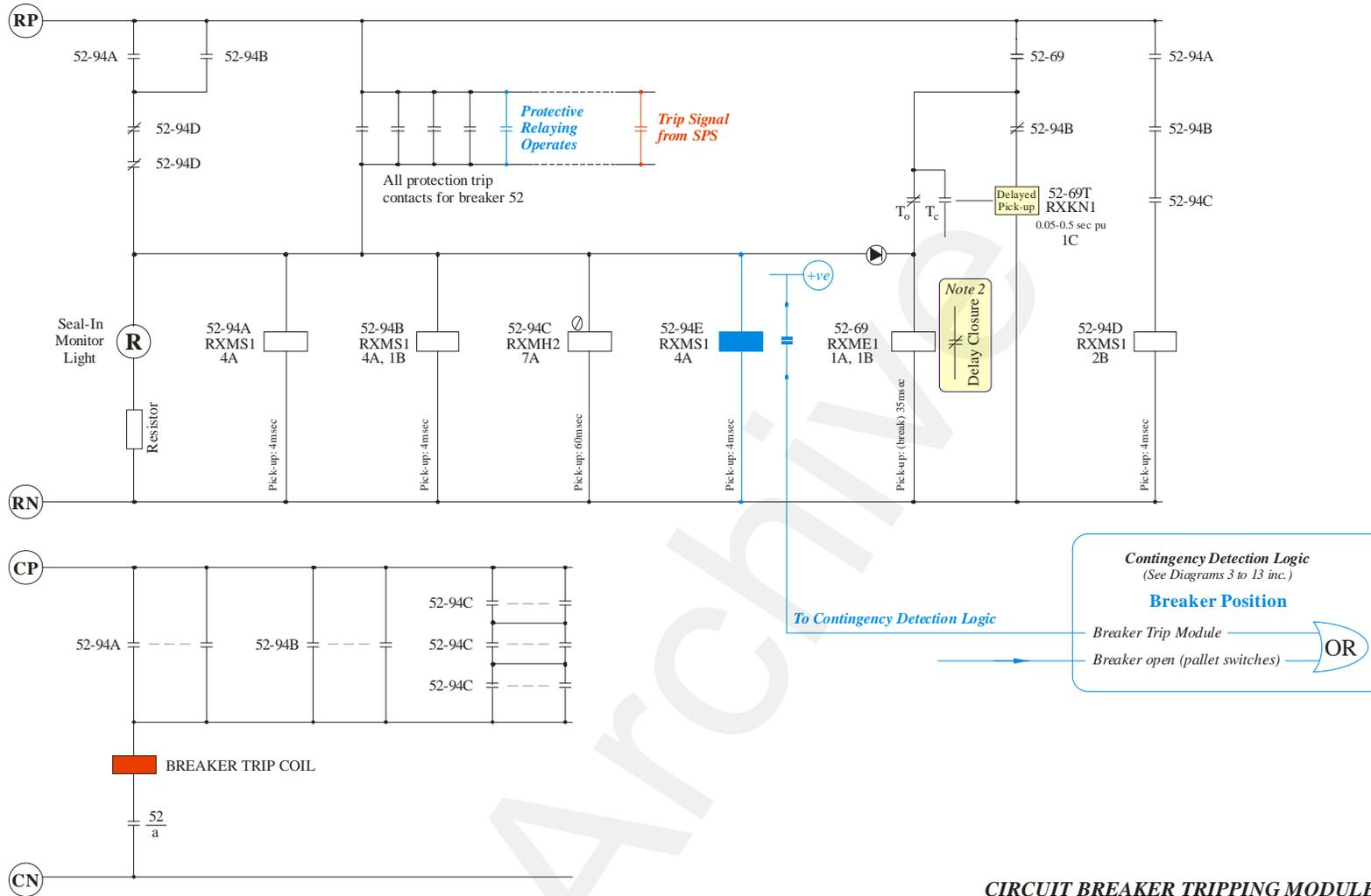
**CIRCUIT BREAKER TRIPPING MODULE REQUIREMENTS**
